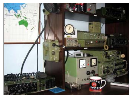
Sl. 30. Deo mil-shack YU1MS (dole desno je stanica PRC-320L, a skroz desno je radio-telefonski sistem "15/12", koji se sastoji od VF uređaja PD-8 i VVF uređaja RUP-12; ovim sistemom se upravlja pomoću upravljačke kutije UK-6)
