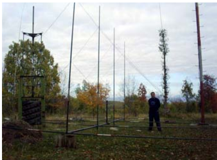
Postavljanje novog 4el kvada za 14 i 28 MHz. Ispred antene na zemlji ponosno stoji Buco YT8T, 2008.
