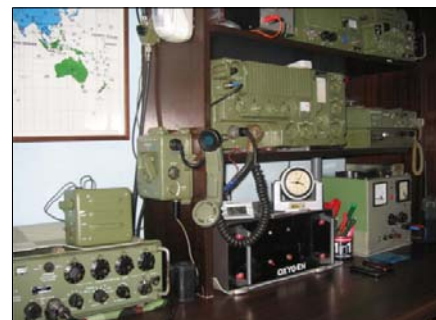
Sl. 29. Drugi deo mil-shack autora YU1MS (levo na slici je uređaj PD-8, desno i pored uređaja RUT-1 je UKT FM 66/17; Iznad nje je RUP-12 sa svojim pojačavačem snage P-25; vidi se i upravljačka kutija UK-6 sa mikrotelef. kombinacijom, MK-1)
