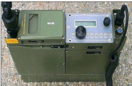
Sl. 86b. Prepravljena analogna upravljačka jedinica sa digitalnim očitavanjem (kolekcija S52PC)
