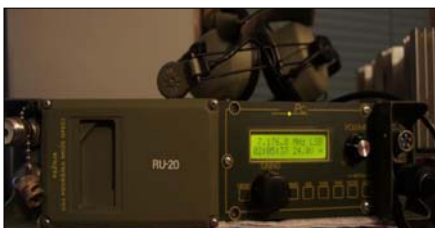
Sl. 86c. Još jedna uspešna prepravka analogne u digitalnu glavu na RU-20. (kolekcija YU1NNN)
