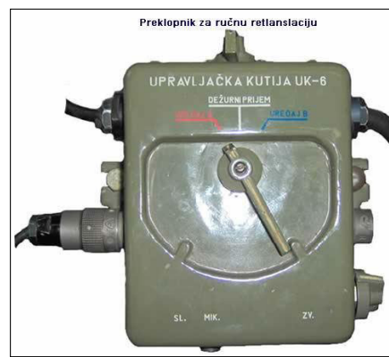
Sl. 82a. Upravljačka kutija „UK-6“ za komandovanje sa uređajima RUP-15 i RUP-12 (sa sajta Radista)
