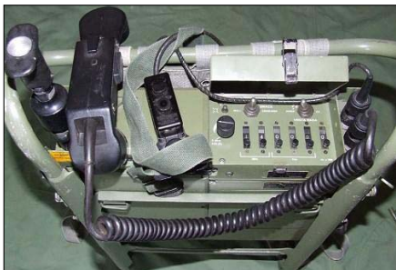
Sl. 83. Domaći RU-20 JNA, na ramu (samaru) za nošenje, spreman za rad
