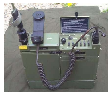
Sl. 83f. RU-20 izvađen iz samara za nošenje sa MTK i štap antenom
