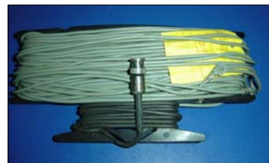
Sl. 83e. Protivteg iz kompleta VF dipol antene AT-35 od RU-20 (kolekcija YU1RDC)
