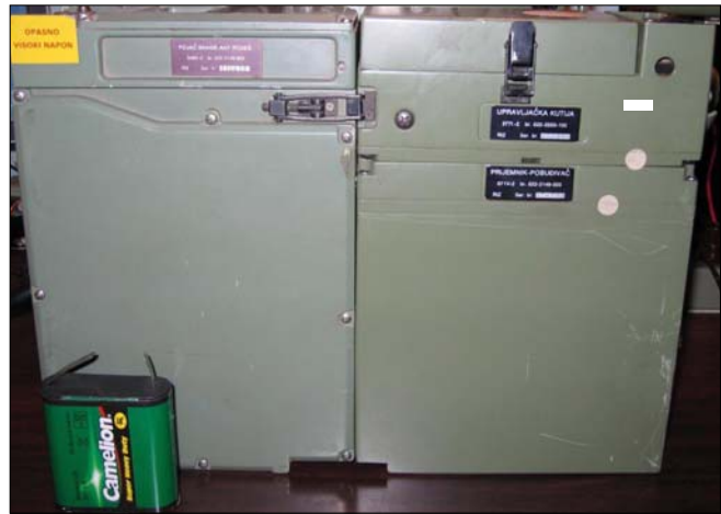
Sl. 84. VF primopredajnik iz kompleta RU-20 izvađen iz rama za nošenje, bez baterije i ručnog generatora
