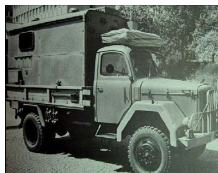
Sl. 89d. Tam 5000D sa nabacnom kabinom
