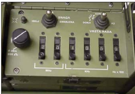
Sl. 83a. BCD prekidači za izbor radne frekvencije na domaćem RU RU-20
