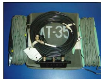
Sl. 83d. Dipol antena „AT-35“ sa spojnicom DS-32, koaksijalnim uvodnikom i protivtegom iz kompleta VF RU RU-20 (iz kolekcije YU1RDC)
