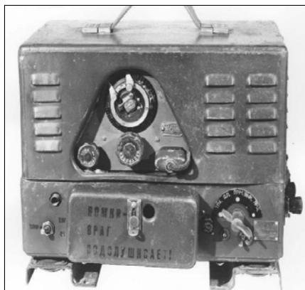
Sl. 90b. Sovjetski radio-uređaj „9-RS“ iz 1944. koji je bio ugrađen u tenk T-34
