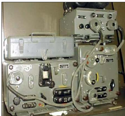
Sl. 90a. Sovjetski radio-uređaj koji je proizveden 1942. i bio ugrađivan u tenk T-34
