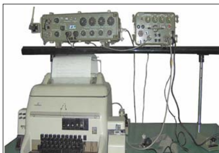
Sl. 89c. Radio-teleprintersko prijemno udaljeno mesto JNA (sa sajta Radista)
