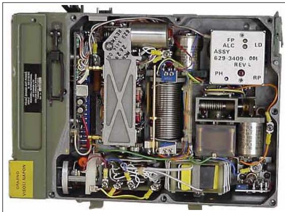
Sl. 83i. Unutrašnjost TX sa strane automatskog antenskog thunera od RU-20
