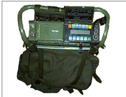
Sl. 87. Novi VF taktički uređaj TRC-20H, koji je urađen na bazi RU-20, a proizveden u Hrvatskoj
