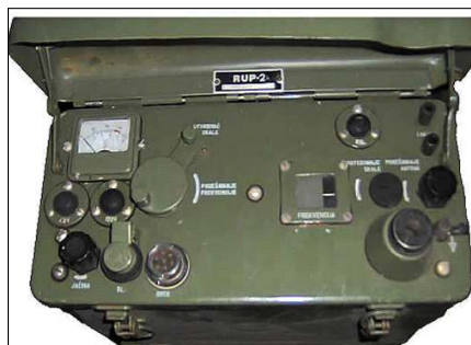
Sl. 4b. Prednja ploča RUP-2 na kojoj se vidi skala koja je označena sa natpisom FREKVENCJA
