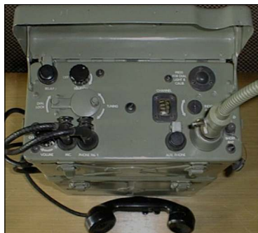
Sl. 2a. BC-1000 spreman za rad; na slici se vidi mikrotelefonska kombinacija koja podseća na telefonsku slušalicu
