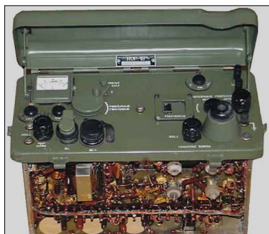
Sl. 4. RUP-1(B) odnosno primopredajnik izvađen iz kutije-donja strana
