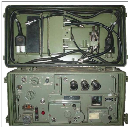
Sl. 5a. Predajnik HD-1 iz kompleta RRU HVT-1
