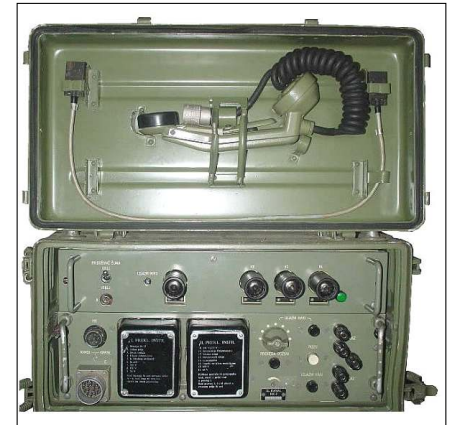
Sl. 5c. Blok službenog kanala HK-1 iz kompleta RRU HVT-1
