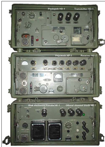
Sl. 5. Prvi domaći radio-relejni uređaj HVT-1 koji proizveden krajem 50-tih godina XX veka u fabrici "Iskra" iz Ljubljane
