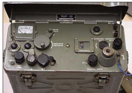
Sl. 4c. RUP-2B, vidi se komanda "Prigušivač šumova"
