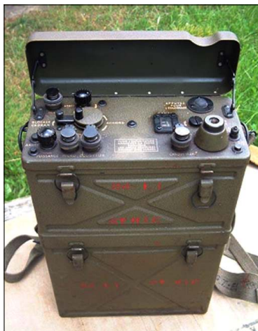
Sl. 2. Američki taktički primopredajnik BC-1000, koji je radio FM telefonijom u frekventnom opsegu od 40 do 48MHz i čija je snaga bila oko 0,3W
